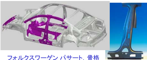
フォルクスワーゲン パサート，骨格 部材の16%が熱間プレス成形
