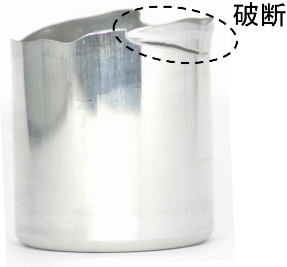
(d)破断 (サーメット, r_r=35.7\% )
