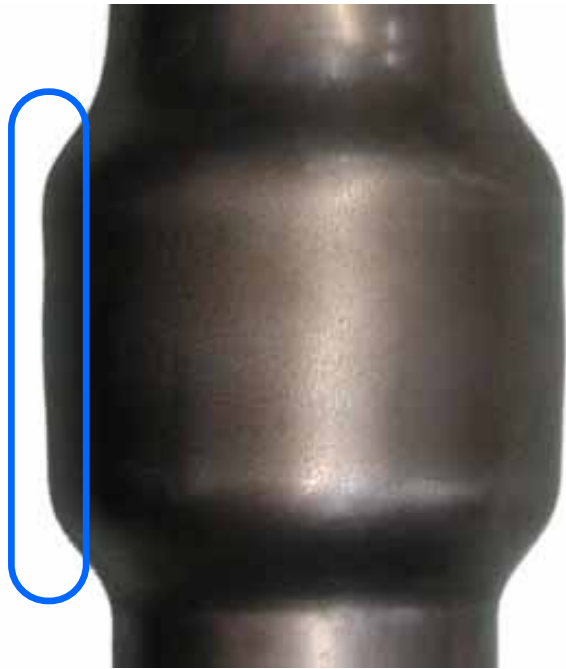
(a) ハンマリング p_0 = 17.7 \text{ MPa} \Delta p = 3 \text{ MPa} , \omega = 0.66 \text{ c/mm}
